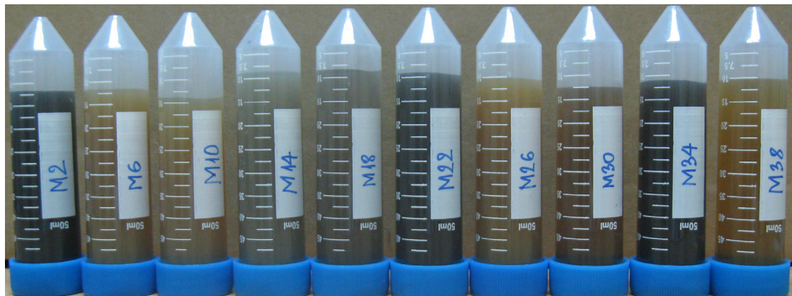
Hình 7: Màu của các sản phẩm nano bạc được điều chế bằng quá trình hòa tan anot với các điều kiện phản ứng như khoảng cách điện cực 500 mm, thời gian biến đổi từ 25 phút (M6, M18, M30), 35 phút (M10, M22, M34) và 50 phút (M2, M14, M26, M38) và đường kính điện cực khác nhau: \varnothing = 3 mm (M2), \varnothing = 4 mm (M6, M10, M14), \varnothing = 5 mm (M18, M22, M26), \varnothing = 7 mm (M30, M34, M38)
