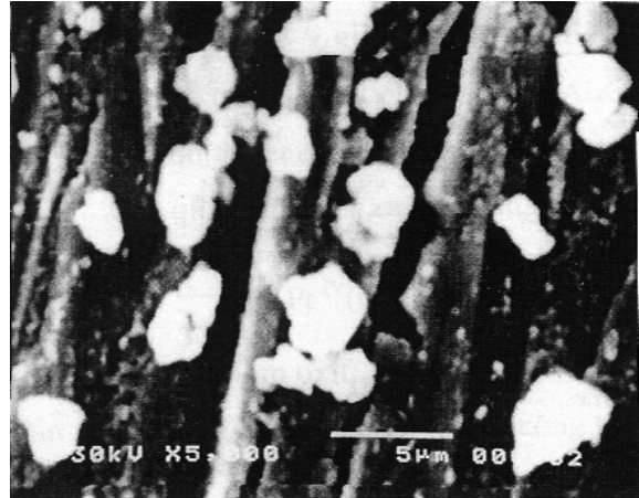
Hình 4: Ảnh SEM của xúc tác chứa 0,6% Pt, sấy 5 giờ ở 120°C, nung ở 200, 300, 400, 500°C (ở mỗi nhiệt độ giữ trong 2 giờ), khử bằng H 2 ở 300°C trong 6 giờ
