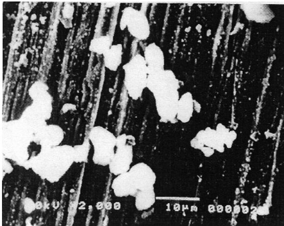
Hình 3: Ảnh SEM của xúc tác chứa 0,3% Pt, sấy 5 giờ ở 120°C, nung ở 200, 300, 400, 500°C (ở mỗi nhiệt độ giữ trong 2 giờ), khử bằng H 2 ở 300°C trong 6 giờ
