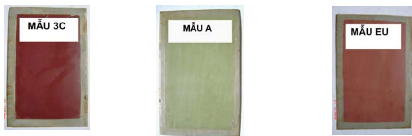
Hình 4: Ảnh chụp các mẫu sơn sau khi thử nghiệm mù muối
