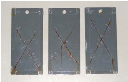
Hình 5: Các mẫu sơn sau khi phơi trong tủ mù muối 960 giờ
