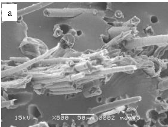
Hình 6: Ảnh SEM bề mặt phá hủy khi kéo của PC gia cường sợi nứa chưa xử lý (a) và có xử lý plasma (b)
