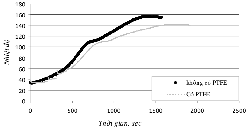
Hình 3: Mối tương quan giữa thời gian và nhiệt độ của quá trình đông rắn có và không có PTFE
