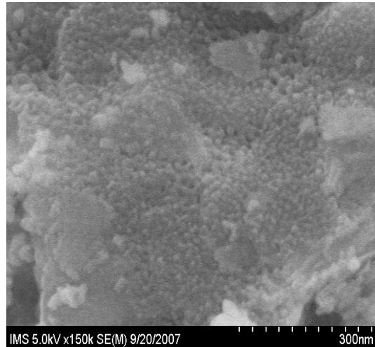
Hình 2b: Ảnh SEM của SiO_2 ngâm tẩm Mn_2O_3
