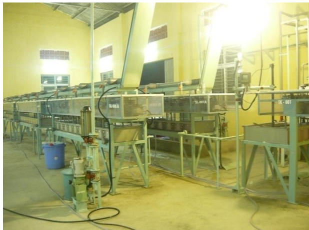
Hình 1: Thiết bị chiết liên tục ngược dòng 120 bậc
