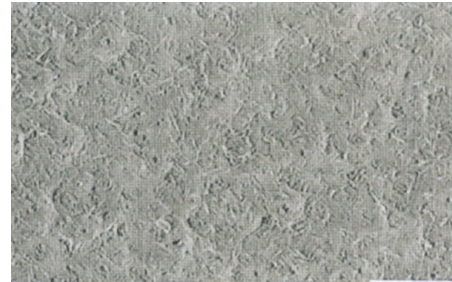
Hình 3: Ảnh SEM bề mặt điện cực sau thủy nhiệt phân
