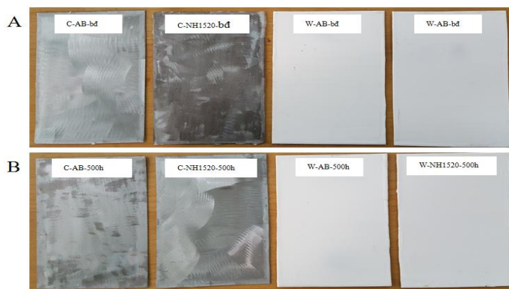
A: Màng Polyurea ban đầu B: Màng Polyurea sau 500h trong tủ Q-sun
