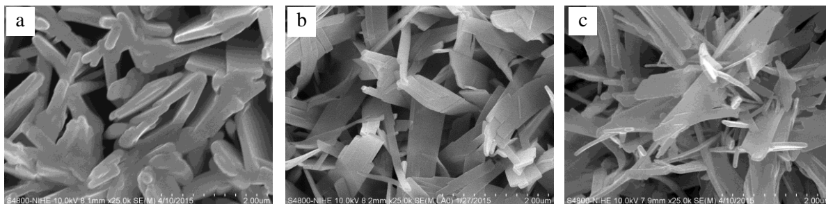
Hình 6: Hình ảnh SEM của màng NaHAp tổng hợp trong dung dịch DNa2, khoảng quét thế 0 \div -1,7 V/SCE, 5 mV/s, 50 °C với số lần quét khác nhau: 3 lần quét (a), 5 lần quét (b) và 7 lần quét (c)
