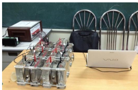
Hình 1: Thí nghiệm xác định độ thẩm thấu ion clo bằng phương pháp đo điện lượng
