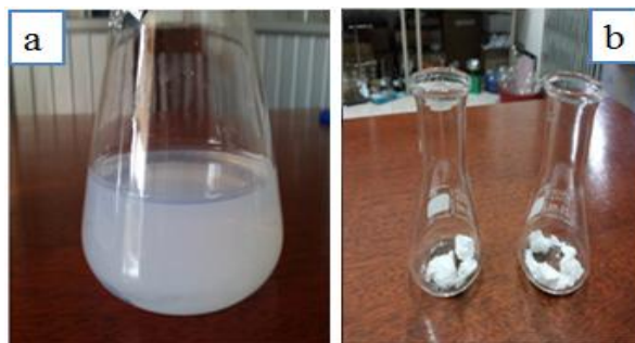
Hình 1: Gel và bột thủy tinh: a-gel thủy tinh thu được từ dung dịch sol sau 5 ngày ngưng tụ; b-bột thủy tinh tổng hợp
