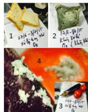
Hình 3: Thí nghiệm về tác dụng khử nấm mốc của ozon trong không khí. Lát bánh mì và các loại quả (được lau khô) đặt trong buồng dung tích khoảng 8 lít. Khí ozon được phun vào bình hai lần cách nhau 1 ngày, mỗi lần 30 phút. Các mẫu được xử lý ozon không có dấu hiệu mốc sau một tuần (1,3). Các mẫu đối chứng (không xử lý ozon) đều bị mốc (2,4), riêng bánh mì bị mốc nặng (2). Sử dụng máy ozon gia dụng sẵn có trên thị trường
