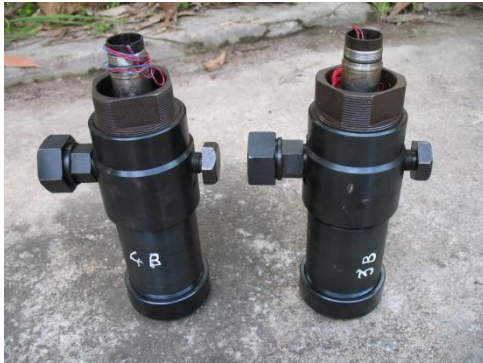
Hình 2: Động cơ mẫu và thỏi nhiên liệu rắn hỗn hợp đã được bọc vật liệu chống cháy VCC-VN-1
