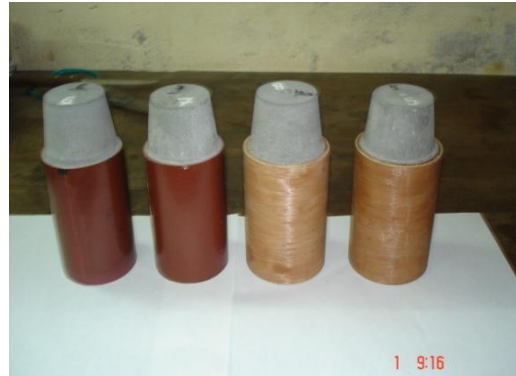
Hình 2: Động cơ mẫu và thỏi nhiên liệu rắn hỗn hợp đã được bọc vật liệu chống cháy VCC-VN-1
