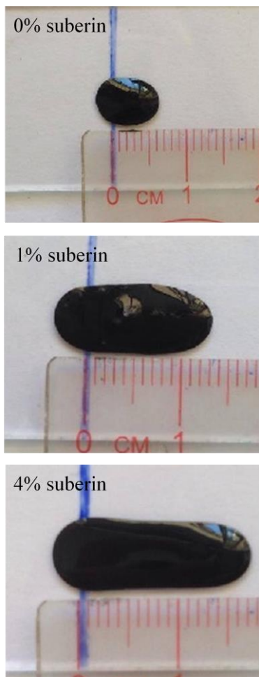
Hình 5: Kết quả đo độ chảy của mực in với các tỉ lệ phần trăm khác nhau của suberin
