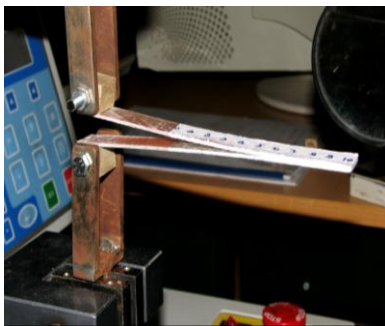
Hình 2: Hình ảnh phép đo độ bền dai phá hủy giữa các lớp của vật liệu compozit
