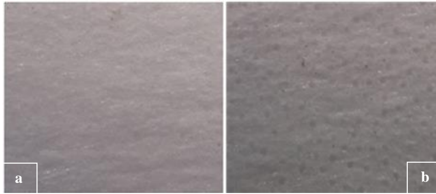
Hình 4: Trạng thái bề mặt màng nhựa AC-261 ban đầu (a) và sau 96 chu kỳ thử nghiệm gia tốc nhân tạo (b)
