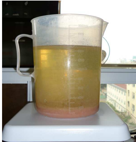
Hình 4. Ảnh tạo thành kết tủa protein sau khi đổ dung dịch anolite vào dung dịch catolite.
