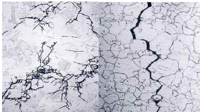
Hình 16. Mặt cắt ngang của thép không gỉ 316 L bị ăn mòn ứng lực, vết nứt hình nhánh cây và lan truyền theo biên hạt
