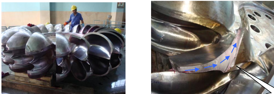
Hình 25. Toàn cảnh bánh xe công tác (a) và cánh gàu số 18 bị gãy (b)
