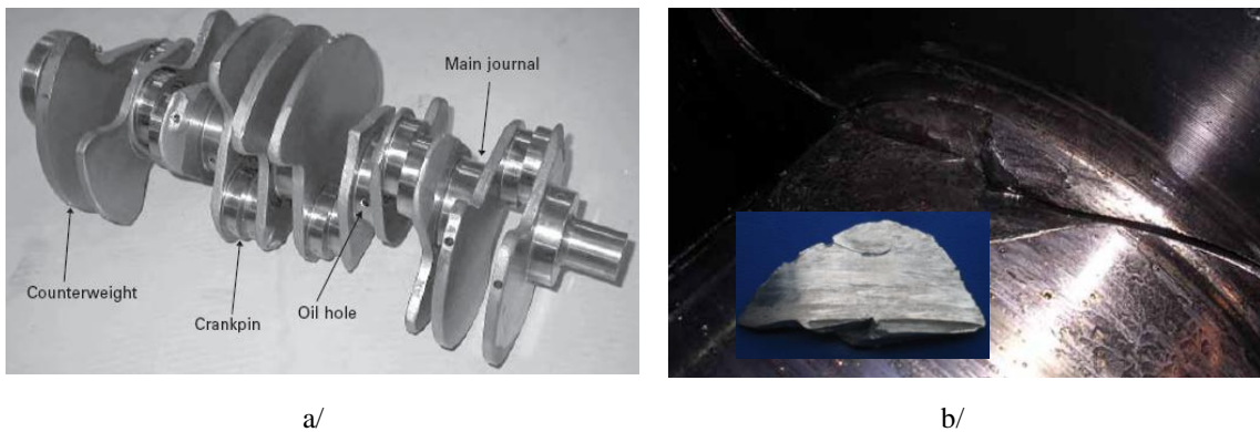
Hình 21. Trục khuỷu động cơ 4 kì (a) và vết nứt trên cổ trục (b).
