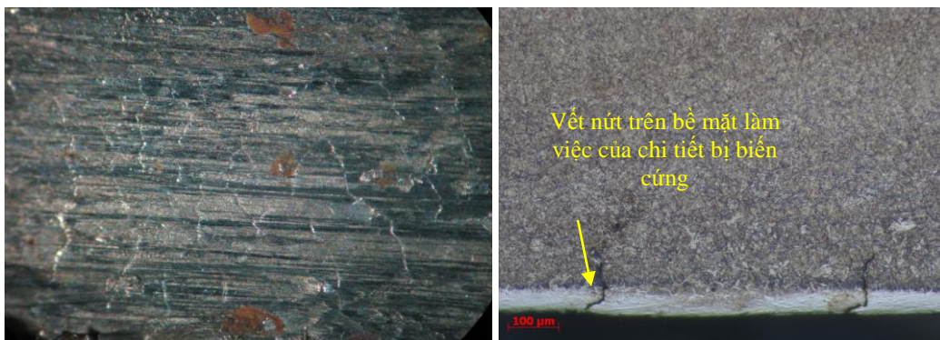
Hình 22. Các vết nứt xuất hiện trên bề mặt trục (a) và cấu trúc tế vi mặt cắt ngang từ bề mặt trục vào bên trong (b)
