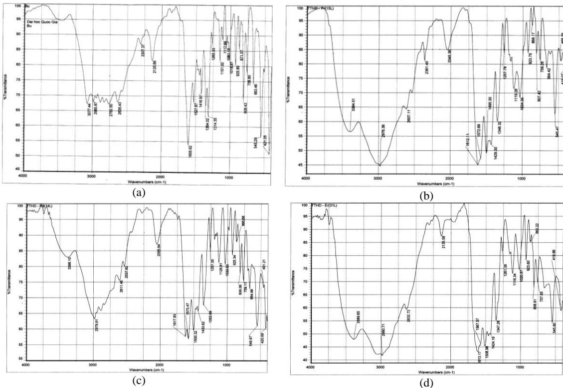
Hình 1. Phổ IR của: (a) Hbu; (b) [Pr(Hbu)<sub>4</sub>]Cl<sub>3</sub>; (c) [Nd(Hbu)<sub>4</sub>]Cl<sub>3</sub>; (d) [Er(Hbu)<sub>4</sub>]Cl<sub>3</sub>.
