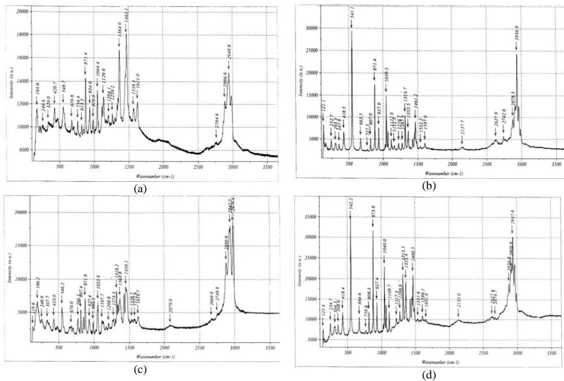
Hình 2. Phô Raman của: (a) Hbu; (b)  $[Pr(Hbu)_4]Cl_3$ ; (c)  $[Nd(Hbu)_4]Cl_3$ ; (d)  $[Er(Hbu)_4]Cl_3$ .
