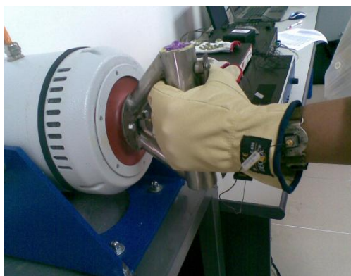
Hình 10. Đánh giá gắng tay chống rung của hãng Vibration theo ISO 10819 (1996)
