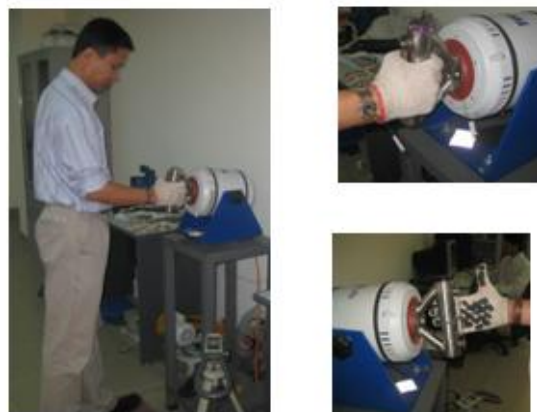
Hình 11. Đánh giá gắng tay chống rung cao su tự nhiên theo ISO 10819(1996)
