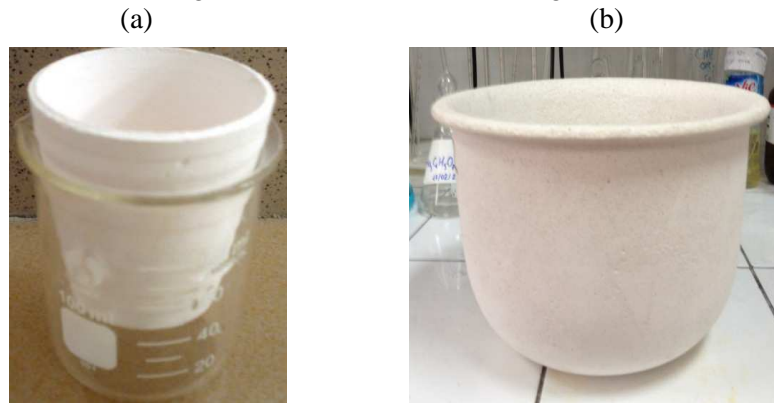
Hình 4. Cốc lọc (a) và bồn lọc (b) gồm cố định nano bạc bằng cách khử trực tiếp trong khi nung.
