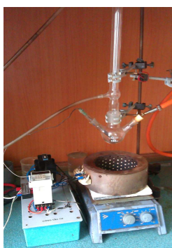
Hình 1. Hệ thiết bị tổng hợp hạt nano hợp kim rỗng CoPt và FePt.
