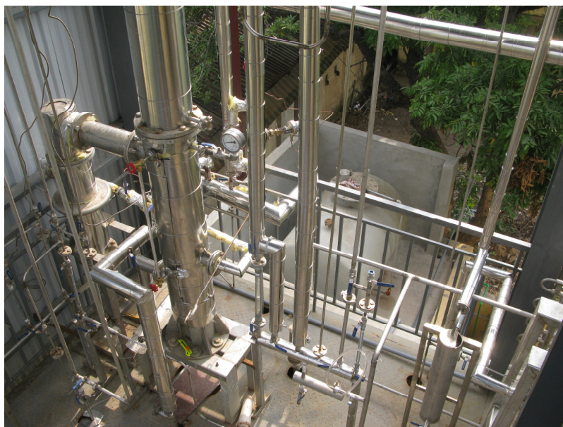
Hệ thống thiết bị tuyệt đối hoá cồn bằng phương pháp không dùng tác nhân hoá học công suất 125 lít/ ngày đêm.
