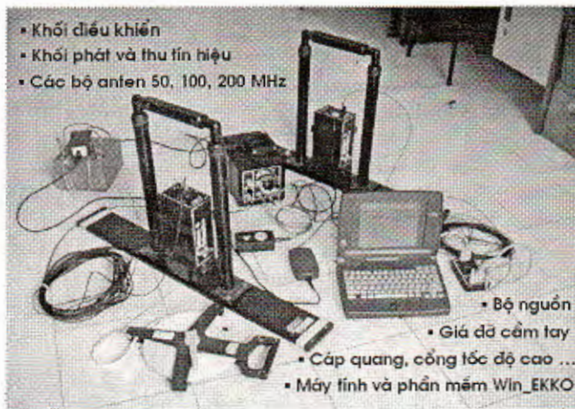
Hình 1. Sơ đồ ghép nối các bộ phận của thiết bị Pulse EKKO 100
