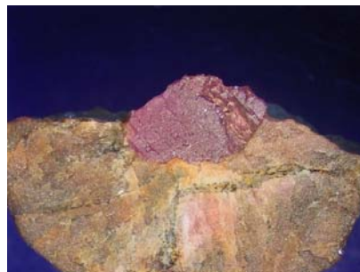
Hình 9. Ruby bị bao bởi spinel
