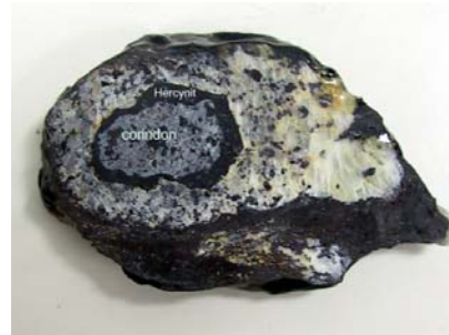
Hình 8. Saphir bị bao bởi spinel (hercynit)
