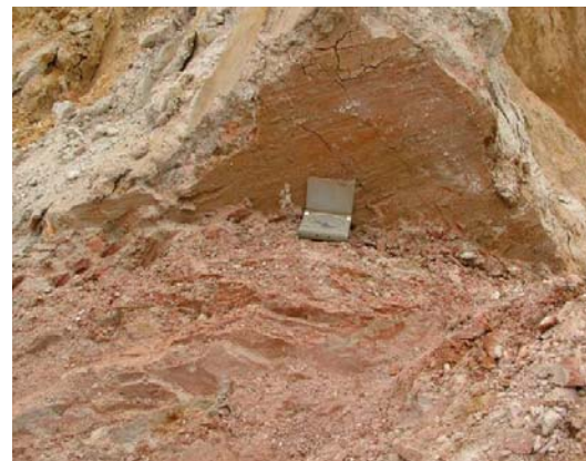
Ảnh 2. Mặt trượt và vết xước kiến tạo (trượt bằng phải) trong lớp vỏ phong hóa (Khu vực trường Cao đẳng Sư phạm Lào Cai)
