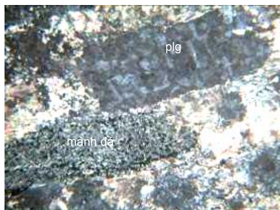
Hình 7. Mảnh đá và mảnh khoáng vật dạng tấm kéo dài, nền bị sericit, calcit hóa mạnh tại khu vực đỉnh Vua. Nicol (+), d = 1,2mm
