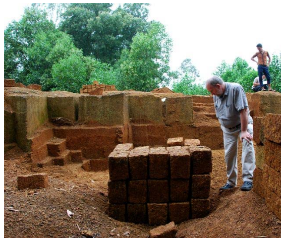
Hình 28. Đầm khai thác đá ong ở huyện Thạch Thất (ảnh Tạ Hòa Phương)
