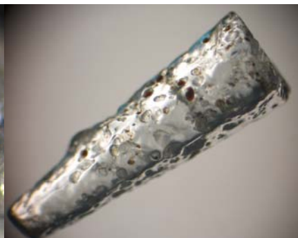
Hình 3. Dấu hiệu hòa tan bề mặt tinh thể corindon
