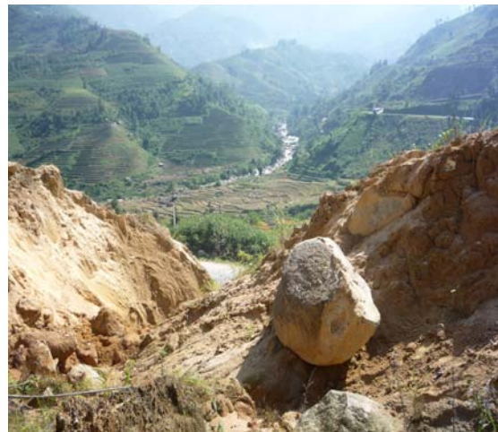
Hình 11. Cơ chế hình thành các dòng nước luân chuyển trong các khe nứt đá granit (trái) và vật liệu phong hóa tại khối trượt I khu vực cầu Móng Sến (phải)
