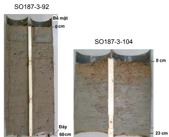
Hình 4. Ảnh chụp hai lõi mẫu SO187-3-92 và SO187-3-104 (hai lõi mẫu được lấy bằng thiết bị boxcorer)
