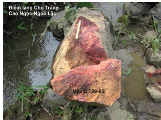
Ảnh 16. Đá đỏ (Jasma) dạng tầng lẫn kích thước nhỏ, đá có kết cấu cứng chắc, phân bố dọc theo các suối nhỏ ở khu vực Cao Ngọc, Ngọc Lặc (Thanh Hóa)
