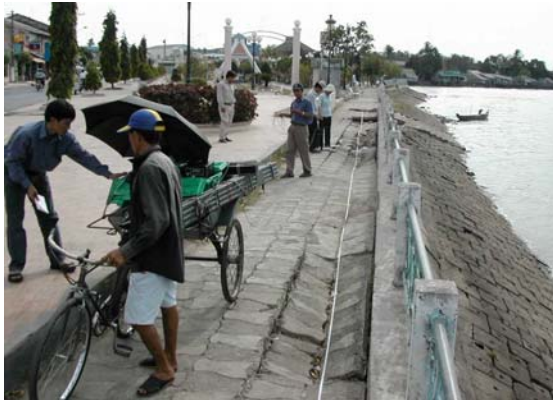
Hình 10. Đoạn đầu của kè Vĩnh Long đang được đo bằng Pulse EKKO 100
