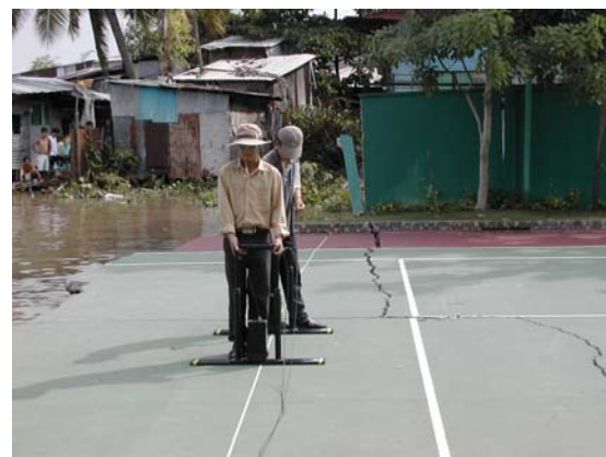
Hình 13. Đo GPR theo tuyến 1 dọc bờ sông tại sân tennis Lý Hoàng bằng thiết bị Pulse Ekko 100 với tần số ăng ten 100 MHz
