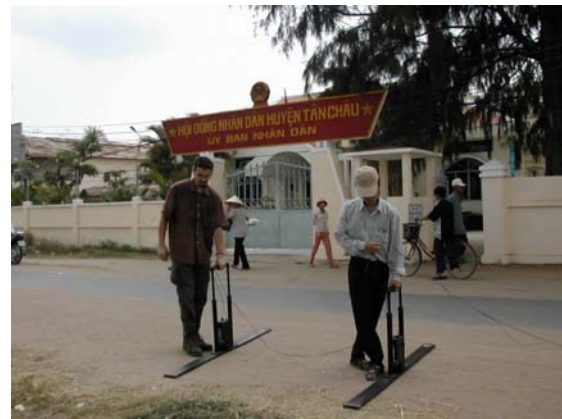
Hình 1. Khảo sát bờ sông Tiền tại Tân Châu bằng GPR
