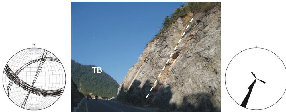
Hình 9. Mặt gián đoạn chính ở sườn dốc điểm Lóng Luông, phương vị góc dốc 200^\circ , góc dốc 60^\circ . Tuyến đường chạy theo phương TB - ĐN. Các mặt gián đoạn thể hiện trên lưới chiếu (trái) và biểu đồ hoa hồng (phải) cho thấy có ba phương cấu trúc chính
