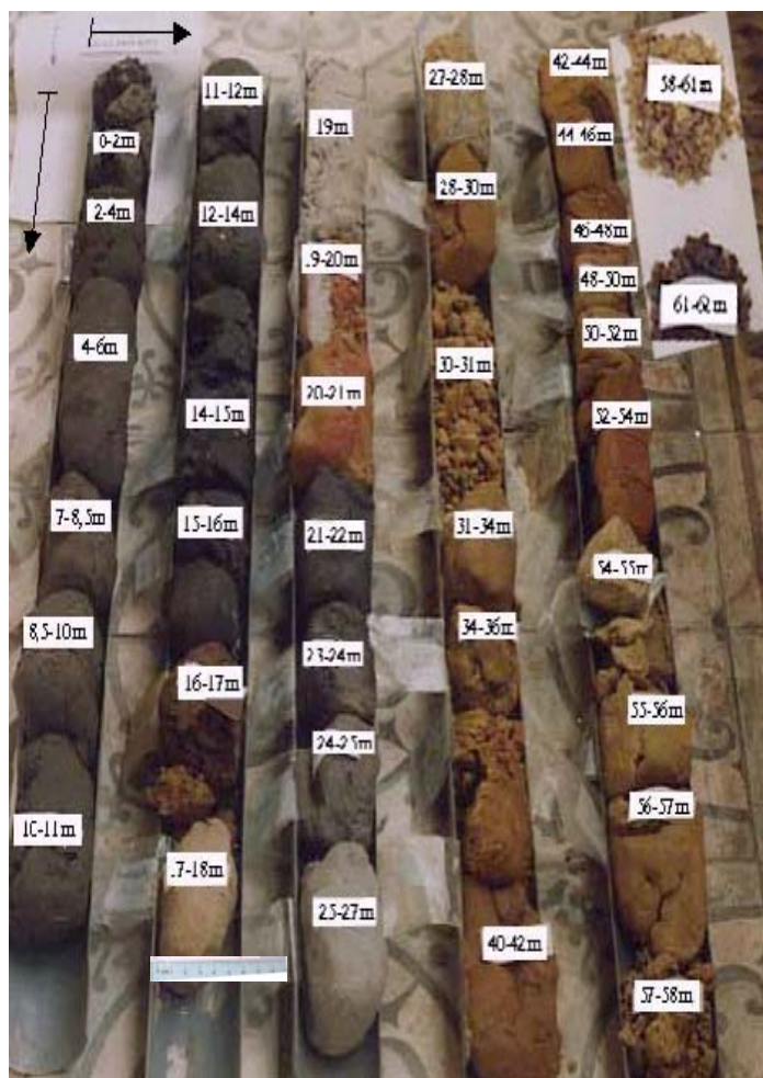
Hình 6. ảnh cột mẫu lõi khoan đáy biển Cẩm Nhượng (lỗ khoan KB1 : độ sâu đáy biển 11,51 m nước, độ sâu khoan 62 m)
