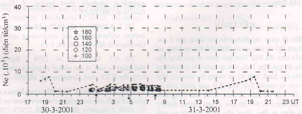
Hình 8. Biến thiên theo thời gian của mật độ điện tử ở các độ cao khác nhau từ 100 km đến 480 km với bước độ cao 20 km vào ngày bão từ 30-31/3/2001 (đường nối liền nét) và ngày yên tĩnh 17-3-2001 (đường nối gạch gạch)
