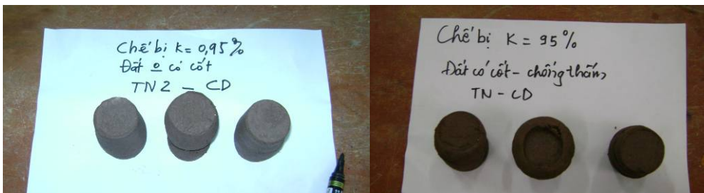
Ảnh 3. Mẫu đất thí nghiệm CD đất không và có cốt VĐKT thấm nước
