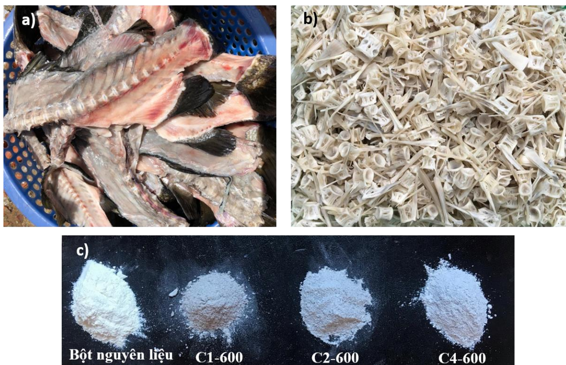
Hình 1. a) Phụ phẩm xương cá chêm Lates calcarifer ; b) Xương trắng loại sạch phần mô mềm; c) Bột nguyên liệu xương cá và các mẫu bột canxi sau khi nung ở 600°C trong khoảng thời gian khác nhau (1, 2, 4 giờ)
