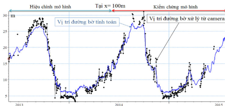
Hình 11. So sánh kết quả mô hình và vị trí đường bờ từ camera tại x = 100\text{ m}
