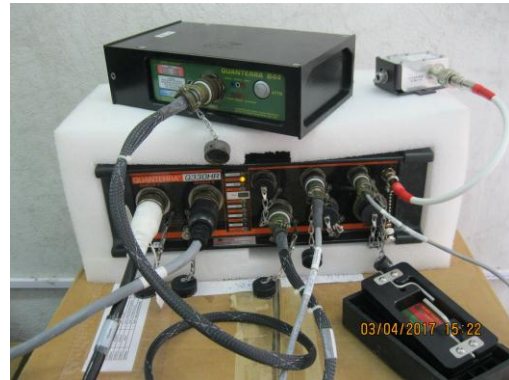
(g) Máy ghi số độ phân dải cao Q330HR và máy lưu trữ số liệu Baler 44, Kinemetrics, Hoa Kỳ
