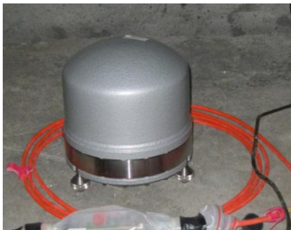
(b) Máy địa chấn dải rộng STS-2.5, 120 giây, Kinometrics, Hoa Kỳ
