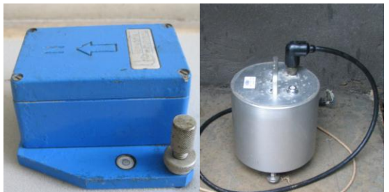
(e) Máy địa chấn chu kỳ ngắn LE-3D; Mark Product L-4C-3D và L-4C-1D
