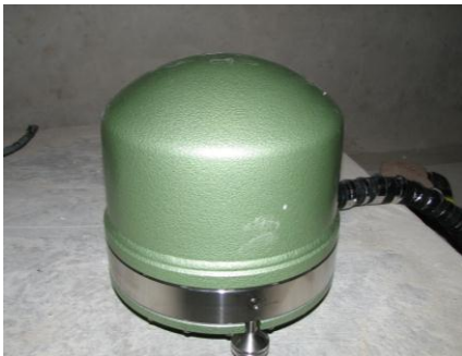
(a) Máy địa chấn dải rộng STS-2.0, 120 giây, Kinometrics, Hoa Kỳ
