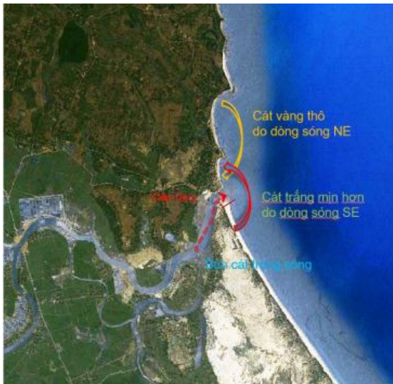
Hình 6. Cơ chế đề xuất cho vận chuyển trầm tích tại bãi tắm Cửa Tùng [1]
