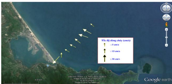
Hình 2a. Phân bố dòng chảy tức thời tầng mặt (2 m) tại mặt cắt Lăng Cô (đo đạc ngày 8/5/2016)
