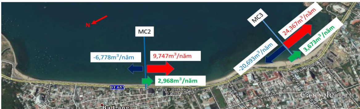
Hình 7. Sơ đồ phân bố lượng trầm tích di chuyển qua các mặt cắt MC2 và MC3 sau 1 năm mô phỏng, kịch bản KB1
