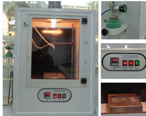
Fig. 2. The actual spray pyrolysis system TST1303
